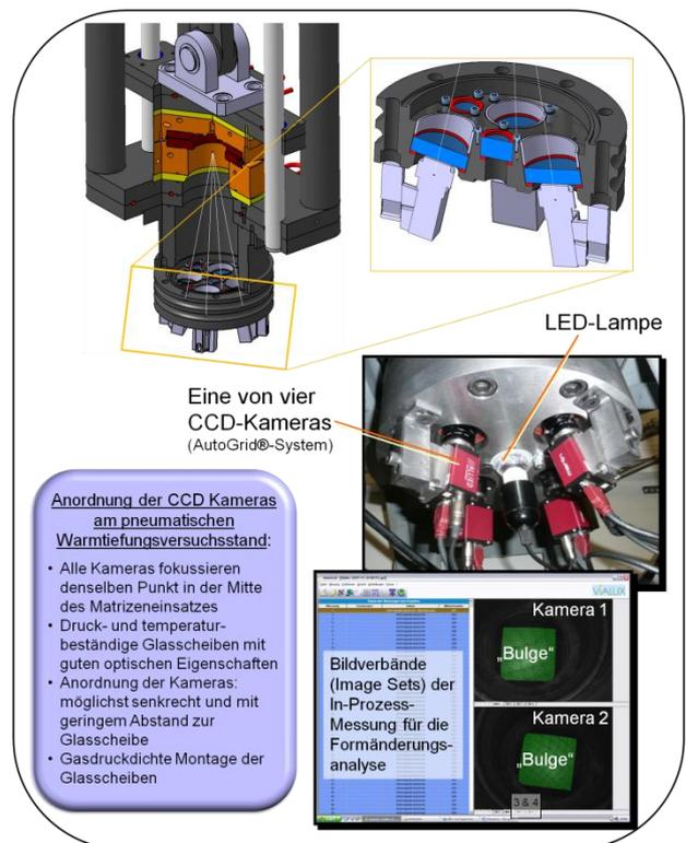
**Bild 3:** Schematische Darstellung der Anordnung der CCD-Kameras am pneumatischen Tiefungsversuchsstand
