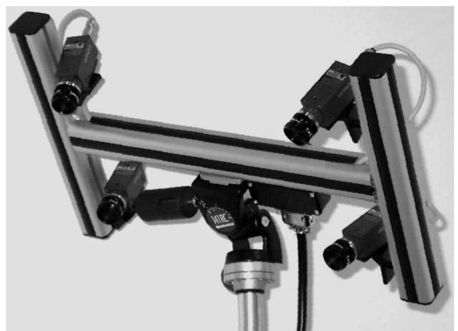
**Bild 4:** Messkopf mit 4 fest einspannbaren CCD-Kameras.
